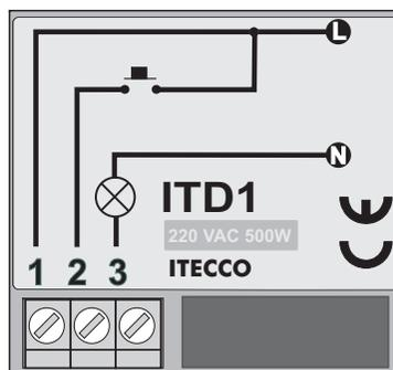
La unidad ITD1 funciona de forma que si mantenemos oprimido el pulsador se regula la intensidad de la luz, dejando de actuar sobre el pulsador en el momento que se alcance el nivel deseado, quedando este ajuste memorizado. Una pulsación breve enciende la luz al nivel previamente ajustado, una segunda pulsación apaga la luz.
