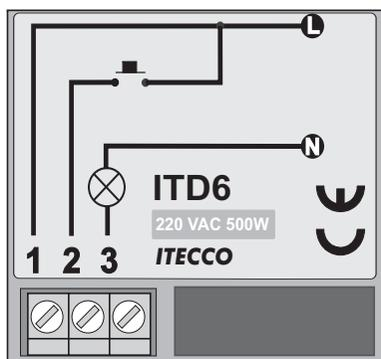
La unidad ITD6 funciona de forma que si mantenemos oprimido el pulsador se regula la intensidad de la luz, dejando de actuar sobre el pulsador en el momento que se alcance el nivel deseado, quedando este ajuste memorizado. Una pulsación breve enciende la luz al nivel previamente ajustado, una segunda pulsación apaga la luz.
